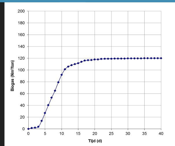
120 nm<sup>3</sup> off biogas / ton max:30% dm
